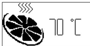
Lorsque la température dans le carter de la turbine d'aspiration a baissé d'environ 10-15°C, le message disparaît et l'appareil est à nouveau opérationnel.
