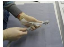
4. Remontez le groupe moteur. Lors de l'assemblage de la pièce à main, alignez l'unité moteur avec les rails de guidage du carénage du moteur. La mise en place n'est possible que dans une seule position et ce, en forçant un peu.
