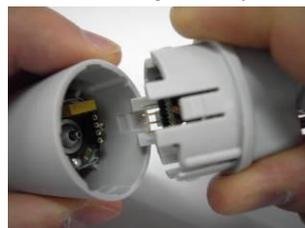
5. Lors de l'assemblage de la connexion du moteur, insérez avec précaution les connecteurs et raccordez la connexion du moteur à la pièce du flexible. Assurez-vous que les connecteurs sont correctement alignés de sorte à ne pas endommager les broches de contact.
